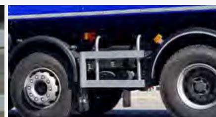
Bočna zaštita protiv podletanja (BZ)
