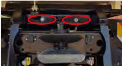
Dvokružna hidraulična instalacija za prikolicu (HIDR2)
