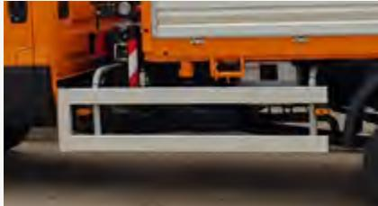
Bočna zaštita protiv podletanja (BZ)
