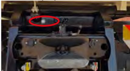
Jednokružna hidraulična instalacija za prikolicu (HIDR1)
