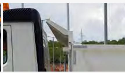
Kosa zaštita kabine i motora na prednjem zidu (Z)
