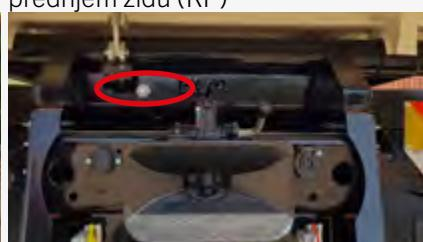
Jednokružna hidraulična instalacija za prikolicu (HIDR1)
