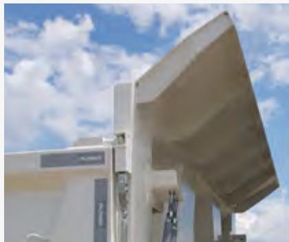
Kosa zaštita kabine i motora na prednjem zidu (Z)
