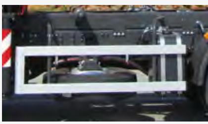
Nosač rezervnog točka (R)
