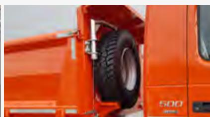
Nosač rezervnog točka na prednjem zidu (RP)
