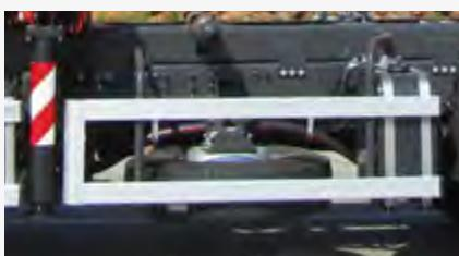
Nosač rezervnog točka (R)
