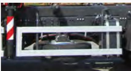
Nosač rezervnog točka (R)
