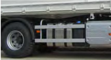
Bočna zaštita protiv podletanja (BZ)
