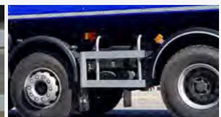
Bočna zaštita protiv podletanja (BZ)
